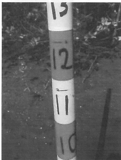
Imagen # 14. Estación escalada y con la marca de mareas más altas registradas.
